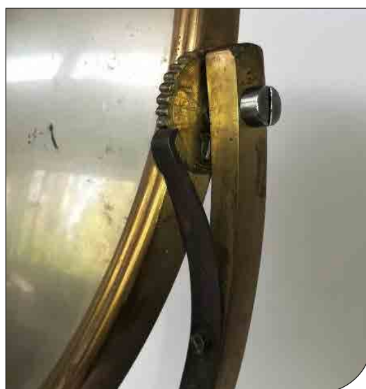
Fig. 5. Meccanismo a molla con ruota dentata per la regolazione dell'inclinazione dello specchio convesso e il bloccaggio dello stesso in posizioni fisse e riproducibili.
