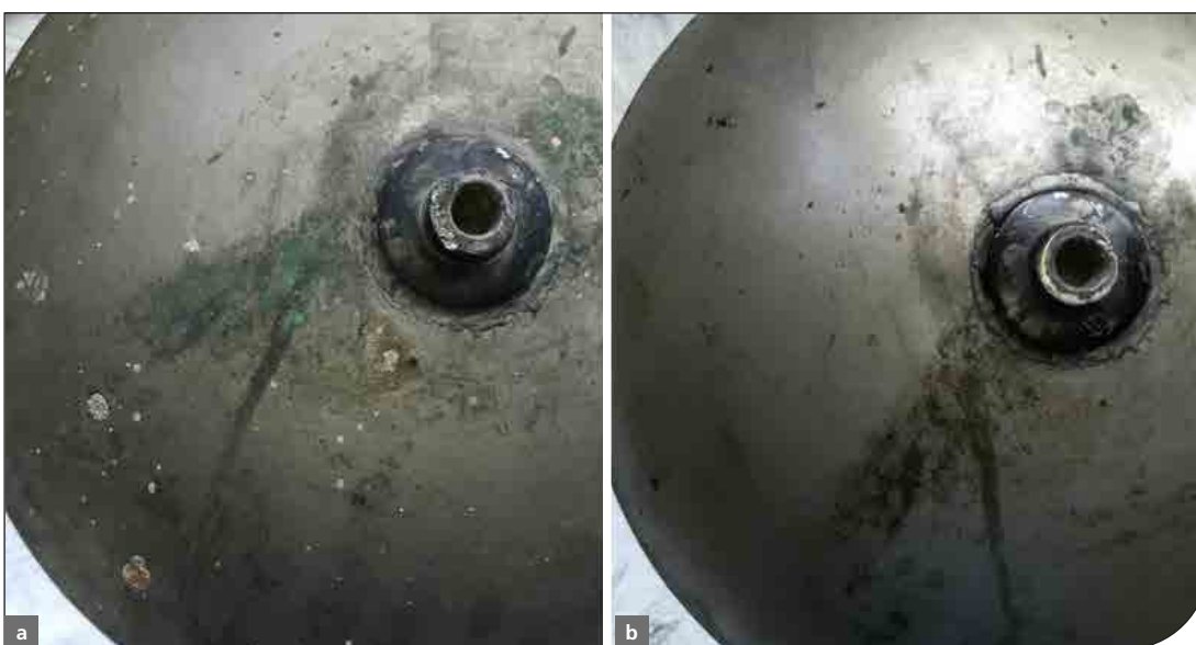
Fig. 7. Immagine della superficie posteriore dello specchio concavo prima (a) e dopo (b) la rimozione dei depositi superficiali.
