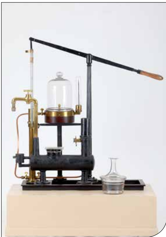
Fig. 10. Macchina di Carré, anni '70 del XIX secolo, costruzione francese, diffusa in Francia nei ristoranti e nei caffè del Secondo Impero, per raffreddare o congelare l'acqua nelle caraffe, inv. n. 845 MFST.
